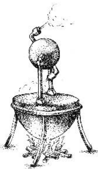
Eolípila. Dispositivo que genera movimiento con la fuerza del vapor.
