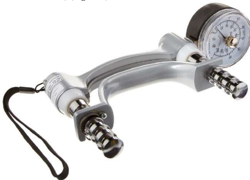
Figura 1. Dinamómetro ( Jamar Hand Dynamometer 5030J1 ) empleado para la evaluación de la fuerza de los miembros superiores.
